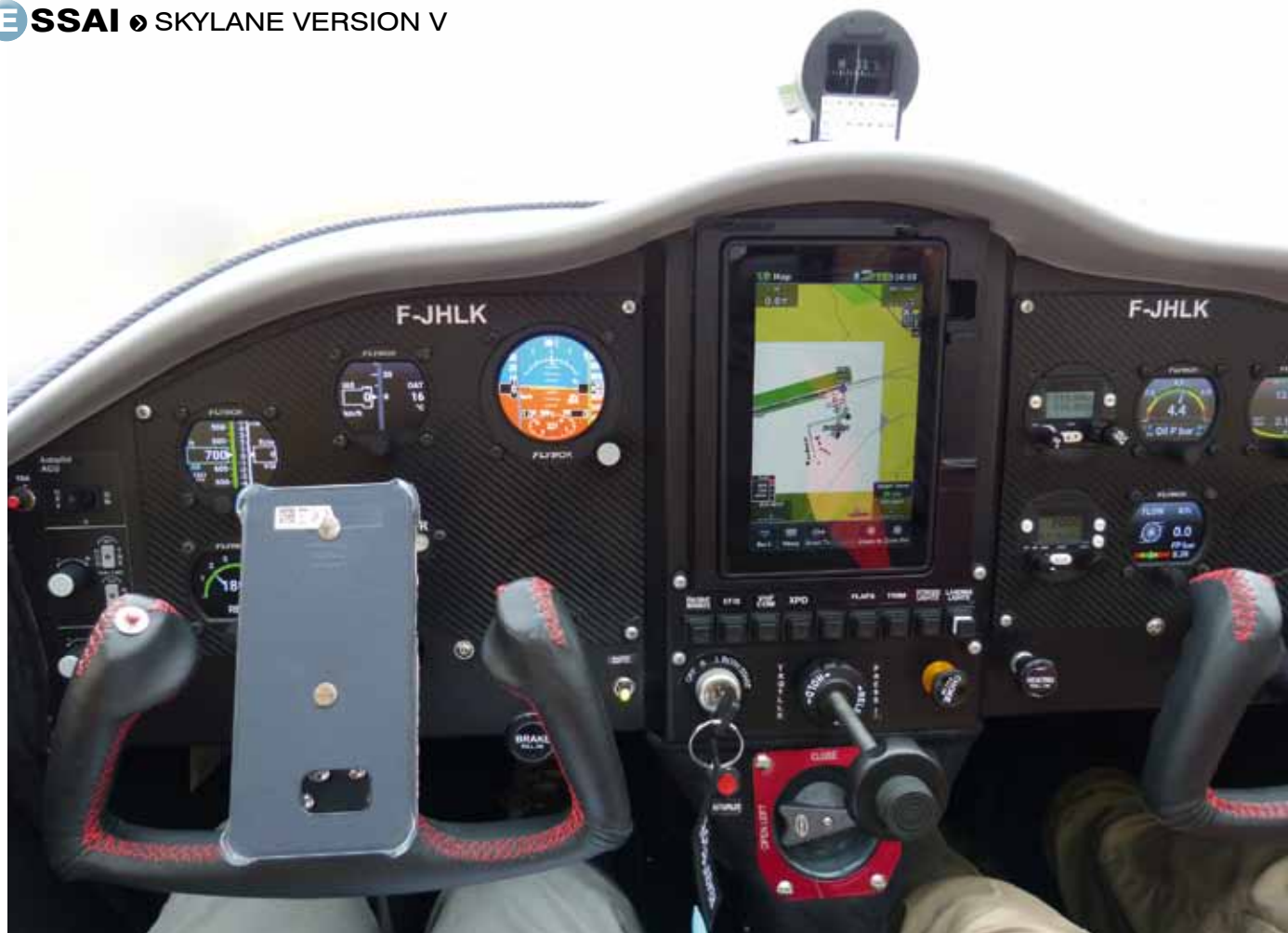
La machine essayée est équipée d'une instrumentation numérique Flybox complète, d'un pilote automatique (panneau de contrôle à gauche), et d'un GPS Garmin Aera 760.
