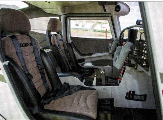
regroupe la commande de gaz, qui permet en plus d'actionner les volets hypersustentateurs, ce qui est malin et pratique, ainsi que la commande des freins qui s'utilise tout à fait logiquement dans le sens contraire au roulage et qui sert aussi de frein de stationnement.
