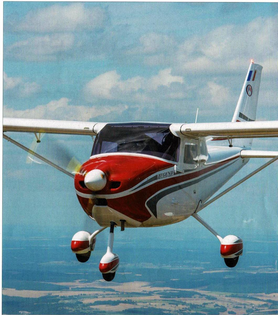
120 km/h (Vy) recommandés. Une fois le moteur réduit, la pompe à carburant coupée et les volets rentrés, j'ai pu noter le joli vario promis, à savoir 1 200 ft/min.
