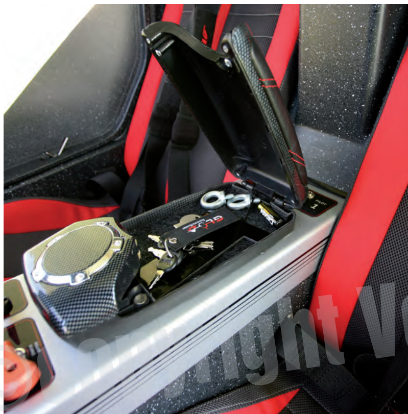
Gros plan sur la commande centrale qui reprend de nombreuses fonctions de trim et de volet. La finition est dans chaque détail. La machine est également équipée de roues-freins Beringer.
